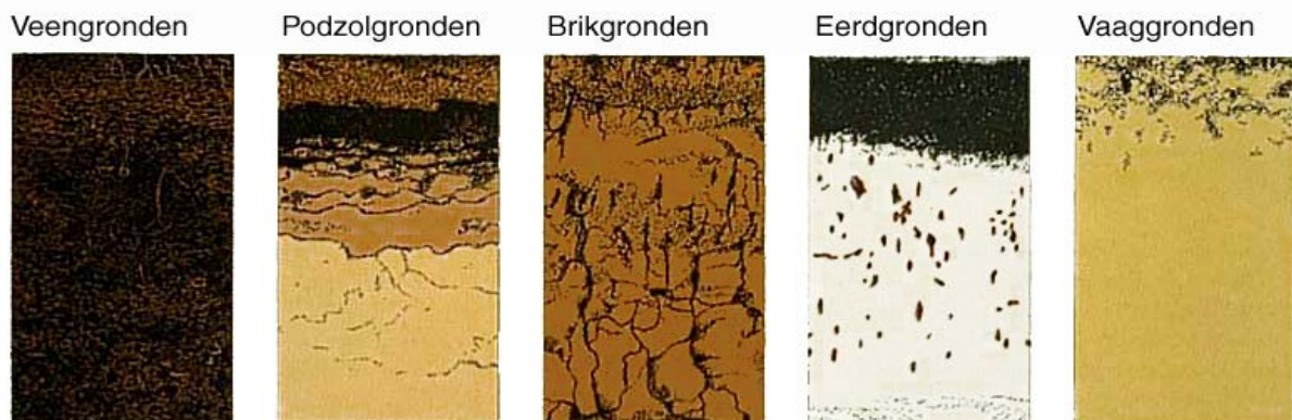
Figuur 3.5 Profielen van de belangrijkste grondsoorten
